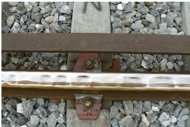
Foto 24. Fijación Nabla rotas en Pk 11,780
