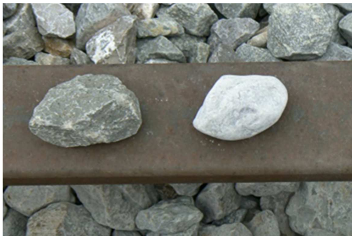
Foto 28. Diferencia de desgaste entre un elemento de origen basáltico y un elemento de origen calcáreo en Pk 10,800
