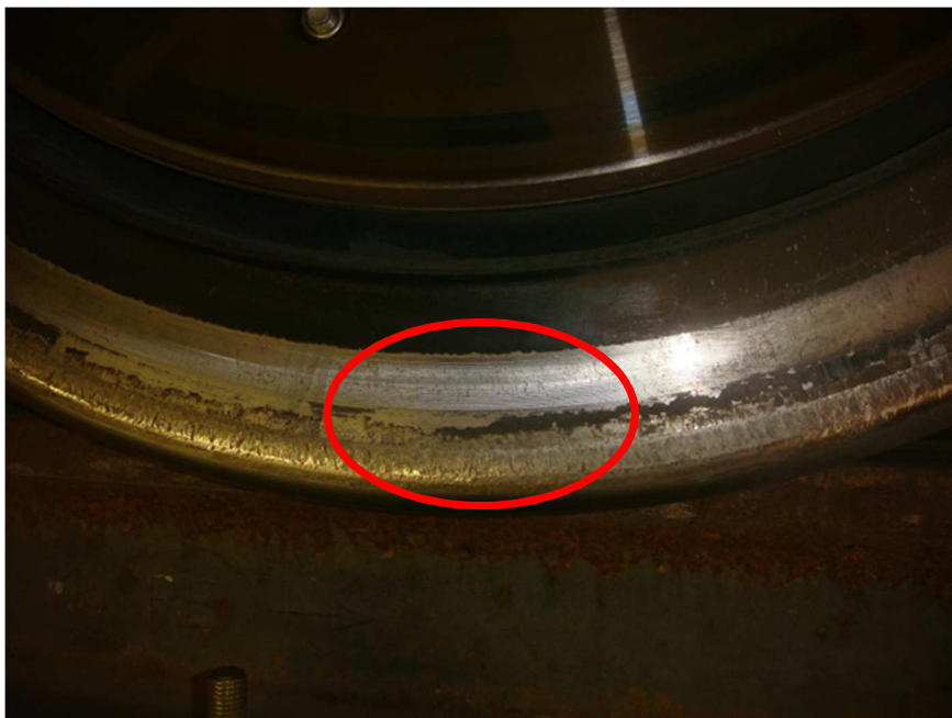
Foto 40. Desgaste anormal de la cara interna
